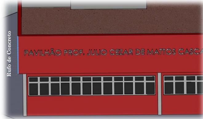
Figura 7 - Rufo de concreto sobre o pavilhão
