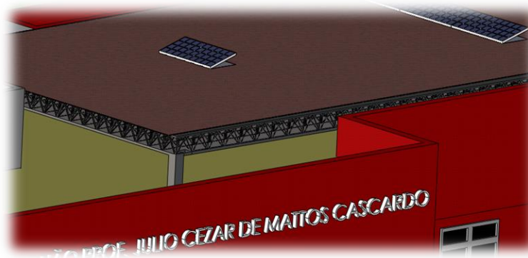
Figura 8 - Modelo de treliça de apoio para elevar os painéis fotovoltaicos
