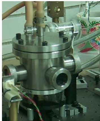
Figura 2. Cámara de gases, fabricada en acero inoxidable
